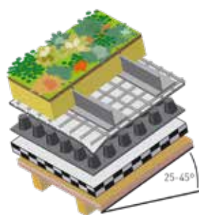
Compositie Nophadrain Extensief Groendaksysteem – steil dak
