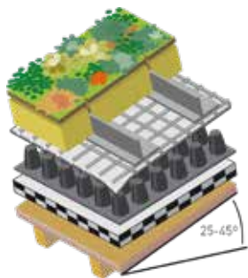
Compositie Nophadrain Extensief Groendaksysteem – steil dak
