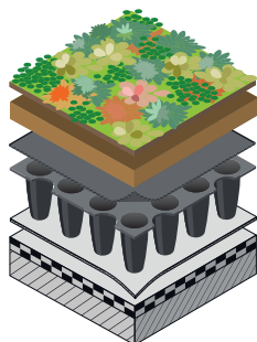
Aufbau Nophadrain Gründachsystem Extensiv mit ND 5+1
